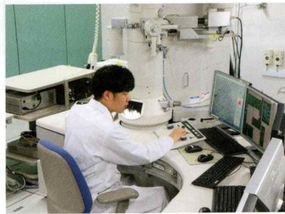
学生が最新の透過電子顕微鏡を操作して、新しい触媒を観察中
