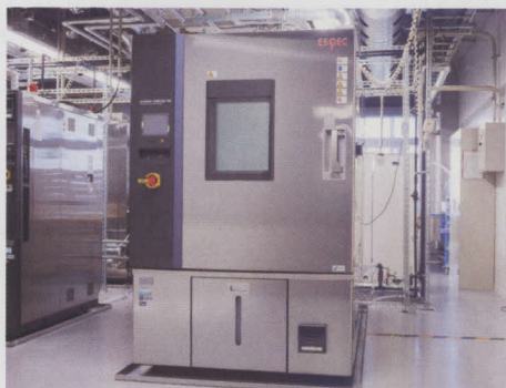
急速温度変化が可能な「ハイパワー恒温恒湿槽」。温度範囲 -70 ~ +180℃、温度変化速度 15℃/分（無試験）に対応。
