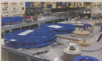
ワイヤーボンディング用電気ニッケルめっきを行う「リール to リール」方式のフープライン。画像解析技術を駆使したIoT化も進んでいる。
