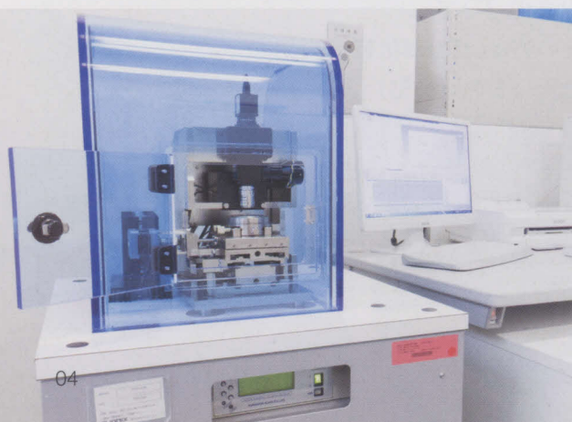
■超微小押し込み硬さ試験機的主要仕様 (株式会社エリオニクス「ENT-2100」)
