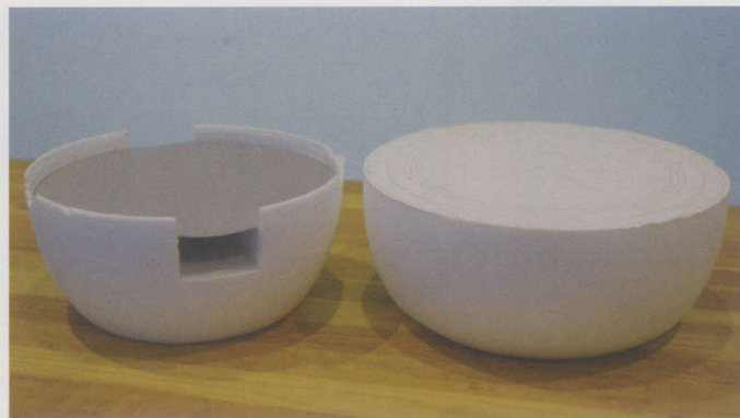
鍋の形状は発泡材を削って検討した。3D プリンターで出力した注ぎ口をはめ込むため、側面に穴を開けている。
