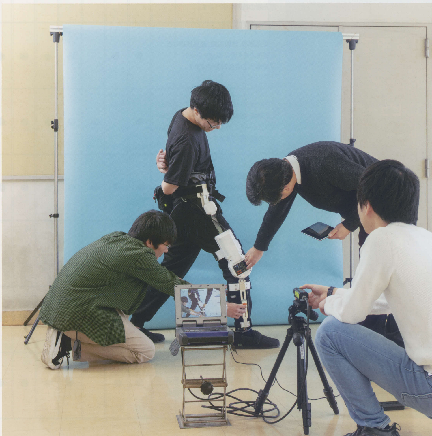
歩行アシストロボットの動作解析の様子
