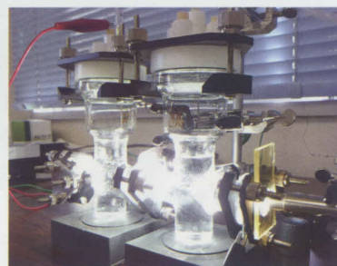
水を水素と酸素に分解するための光化学反応実験
