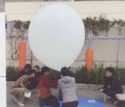
気象観測用の風船を膨らませる (下に測器を付けて飛ばす)
