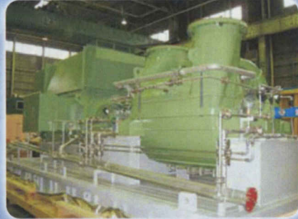
硫黄回収(SRU)プロウ 鑄鉄製水平二ツ割多段ターボプロウ 口径:700×600mm 動力:930kW
